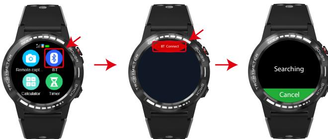
Als u Android gebruikt, zal er automatisch een pop-up met een bluetooth-koppelverzoek verschijnen. Het BT-pictogram linksboven op het horloge wordt blauw en oranje . Dit betekent dat BT3.0 en 4.0 succesvol zijn gekoppeld. (Opmerking: 3.0 wordt gebruikt voor de oproepen)
