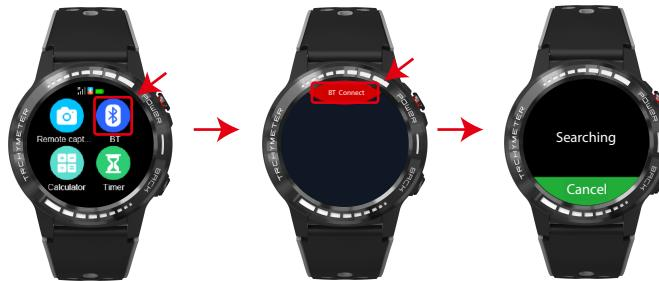
Pour les utilisateurs d'Android, une demande de jumelage bluetooth apparaîtra automatiquement sur le téléphone et il suffira de cliquer sur le bouton de jumelage. L'icône BT en haut à gauche sur la montre deviendra bleue et orange ce qui signifie que BT3.0 et 4.0 sont connectés avec succès. (Remarque : la version 3.0 est utilisée pour les appels)
