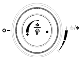
(Bouton vapeur/eau chaude) Position arrêt
