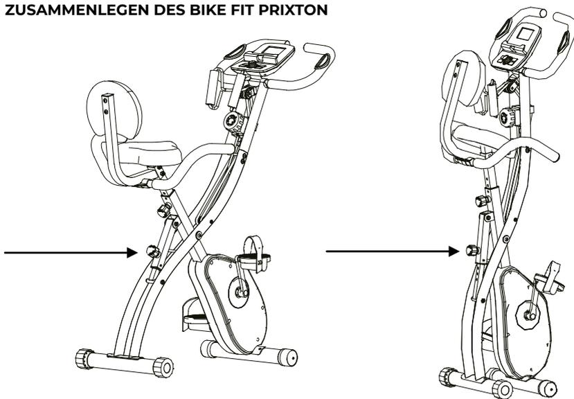
Ziehen Sie die Schraube der Hauptachse heraus und setzen Sie diese wieder ein, wenn das Fahrrad zusammengeklappt ist.
